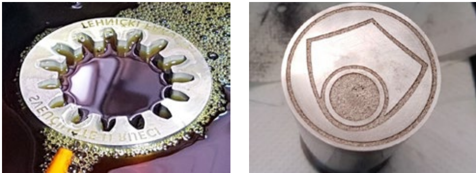
Topli umetak i trn nakon procesa elektroerozije / Mold inserts after EDM processes
