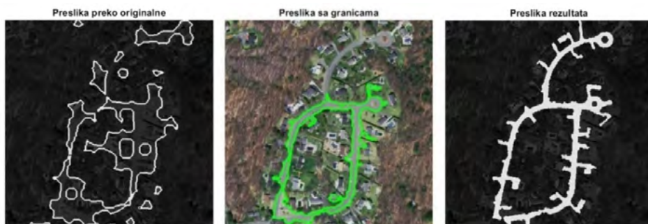
Usporedba metoda koje se temelje na grafičkim značajkama (slika u trećem stupcu je rezultat korištenja predloženog modificiranog algoritma) / A comparison of methods based on graphical features (the image in the third column is the result of using the proposed modified algorithm)
