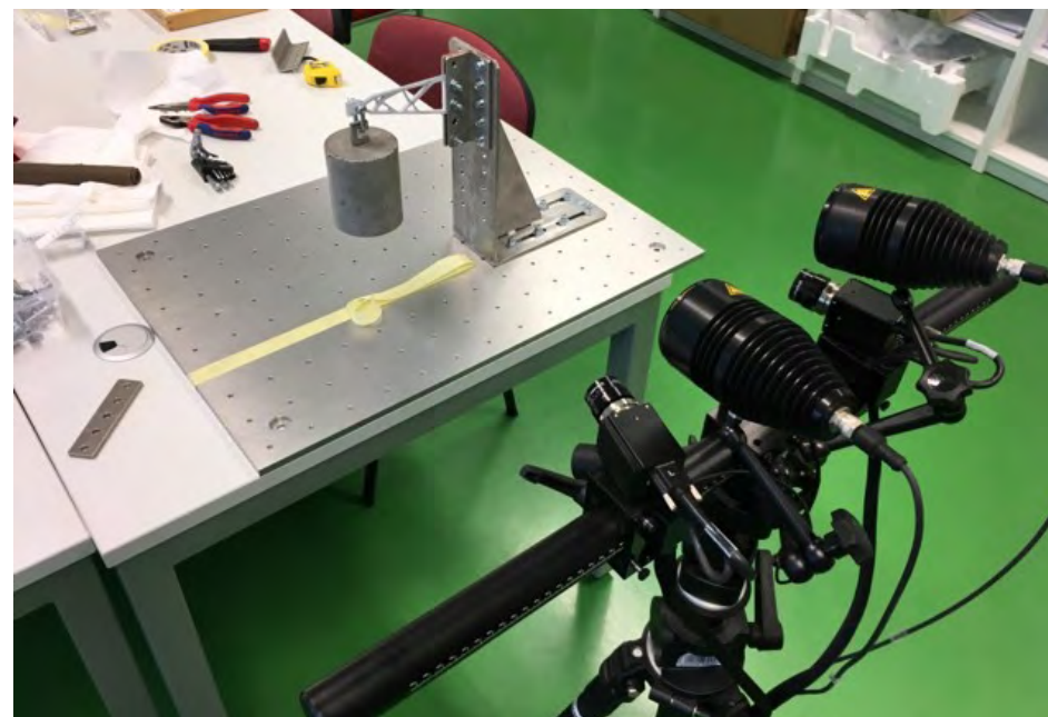
Eksperimentalno-mjerni sustav s opterećenim uzorkom / Experimental and measurement setup with loaded optimized sample
