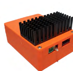
Istosmjerno trošilo smješteno u 3D ispisano kućište / DC load electronics housed in a 3D printed housing
