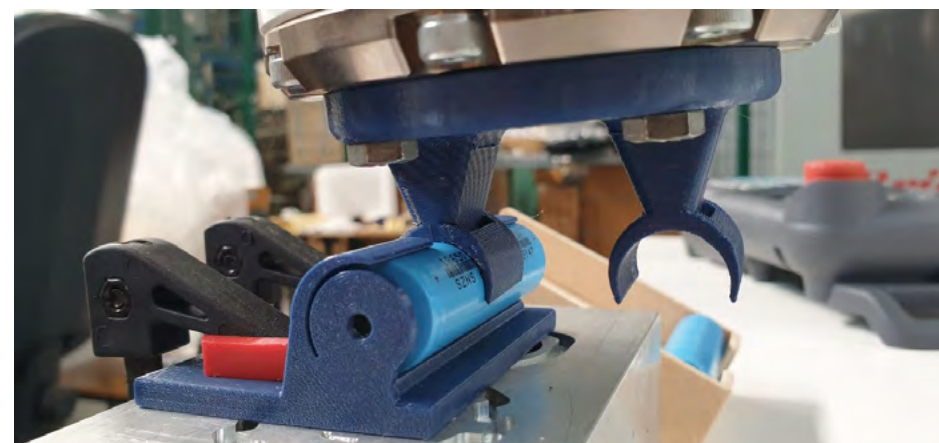
Postavljanje litij-ionske baterije na stanicu za mjerenje robotskom rukom / Placing lithium-ion battery on a discharging station using a robotic arm
