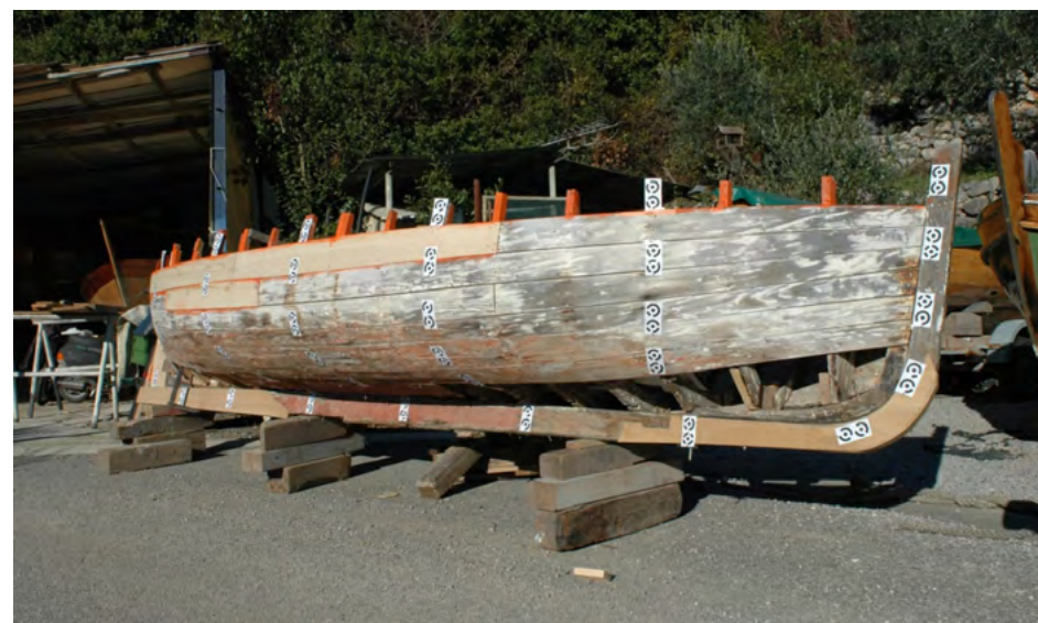
Pozicionirane oznake na brodu / Boat with photogrammetry markers
